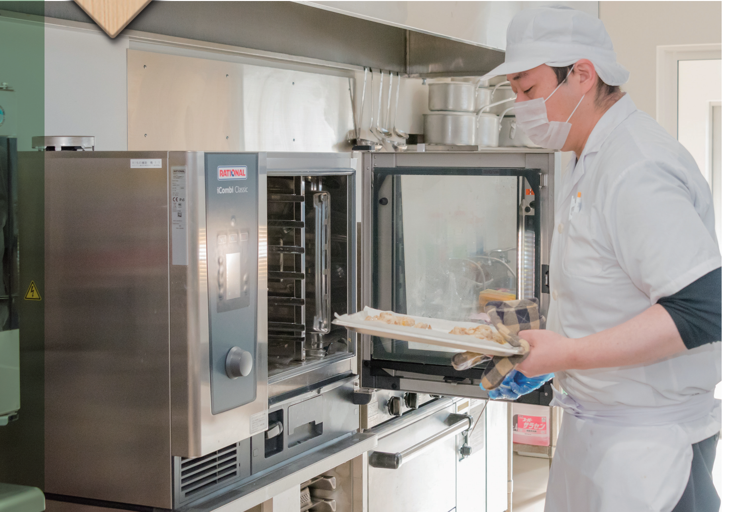
オープンに蒸気発生装置を取り付けたスチームコンベクション。熱風と蒸気を利用して「焼く」「蒸す」「煮る」「茹でる」「炒める」「炊く」などさまざまな調理ができる
