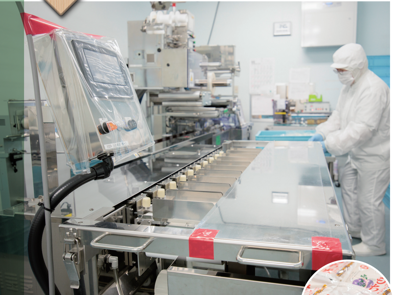
切り餅の製造ラインに導入された計量機。裁断した餅を計量台上載せると、指定した個数と重量の組み合わせが自動的に選別される
