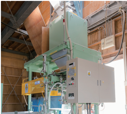
自動包装機と移動機の導入により、1日4時間だった作業時間が8時間に拡大。1日当たり24tの袋詰めが可能になった。
